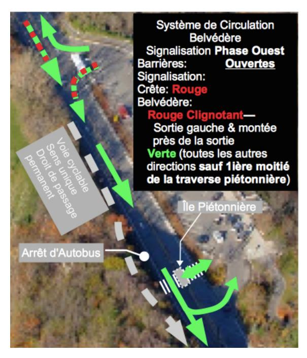
Vue aérienne de la système de circulation proposée, à la belvédère— signalisation phase **ouest**. Egalement avec explication écrite dans la soumission écrite nouvellement révisé (7 Dec), pp. 21-25 de ASensibleTraverseOfMountRoyal-RDec7.pdf— inclut avec le courriel enveloppant.
