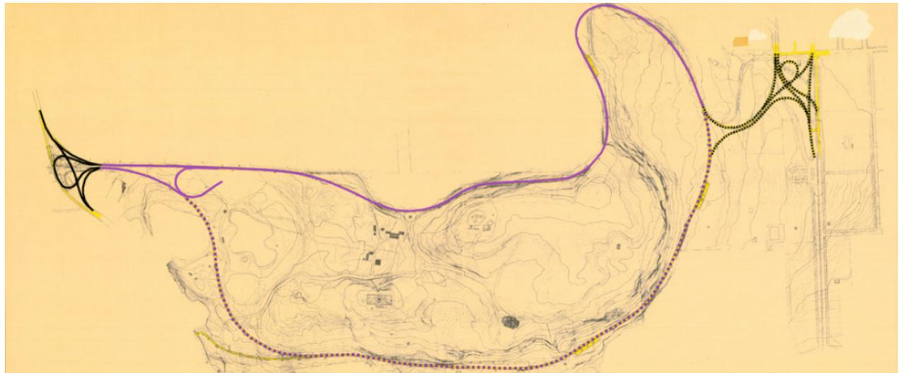
Vers 1955. Cette esquisse montre le tracé préliminaire de la route de ceinture et des échangeurs situés à chaque extrémité. Le tracé surligné en violet identifie la route de ceinture et celui en noir, les échangeurs. Les traits continus surlignés indiquent ce qui sera réalisé et le trait en pointillé ce qui ne le sera pas. Sans titre. VM. SGPVMR. 0225-021\_vers 1955\_Plan du projet des chemins Camillien-Houde et Remembrance\_GP39.
