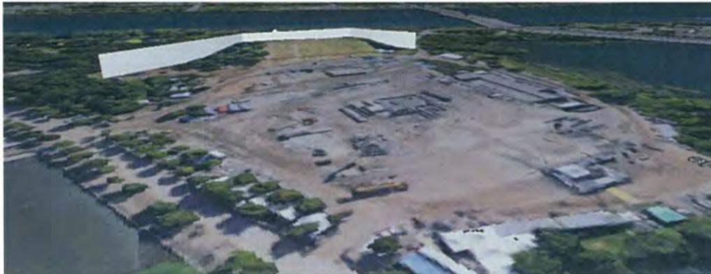
Figure 20 : Vue 3-D d'écran de 5m au-dessus de la butte (12 m par rapport à la partie plate du site)
