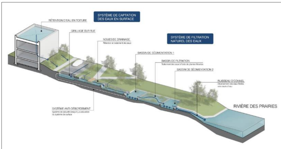
Figure 8. Axonométrie démontrant le fonctionnement des noues et du traitement des eaux de pluie à l’échelle d’un quartier. Source : Pierrefonds, Secteur Ouest, Cap-Nature (OCPM, 2017).
