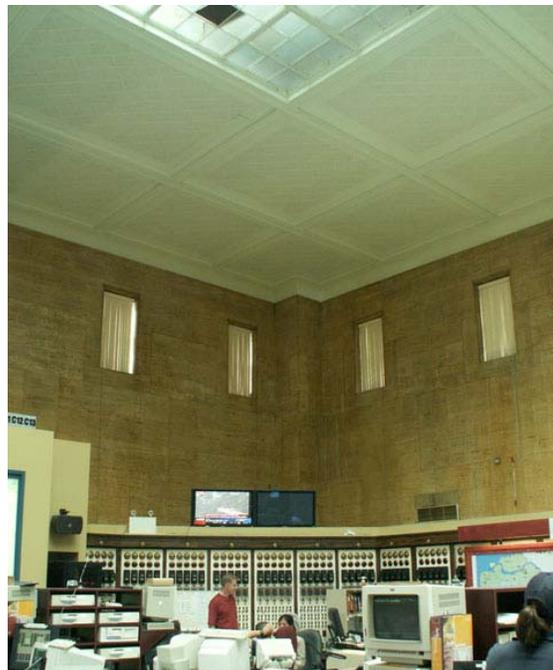
Figure 24 : Salle des opérations : plafond suspendu, puits de lumière, fenêtres hautes et petits murs soutenant l'ancien système d'alarme.
