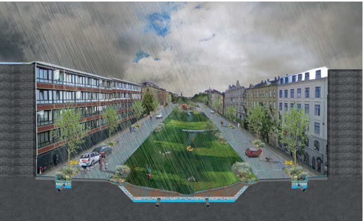
Aménagement d'une rue dont les mesures de gestion des eaux pluviales favorisent l'infiltration naturelle et la résilience aux inondations © Studio Dreiseitl
