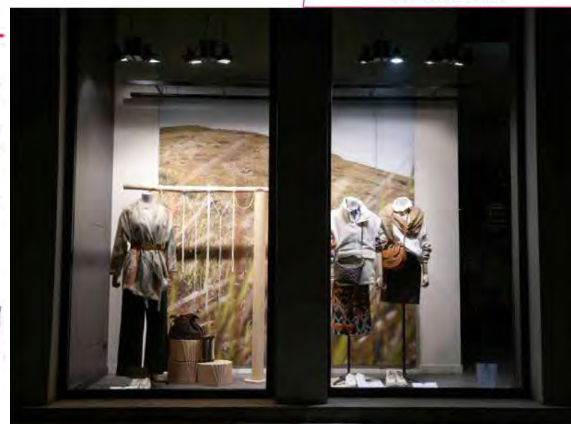
Éclairage discret, doux et homogène ; orientation correcte des projecteurs (peu de débordement sur l'espace urbain et aucune gêne visuelle pour le passant).
