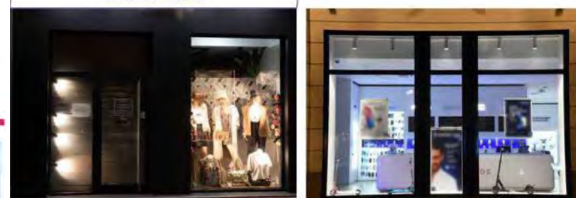
Éclairage trop contrasté et trop fort ; éclairage du plafond, contraste trop fort avec l'intérieur du magasin ; éclairage d'une partie occultées.
