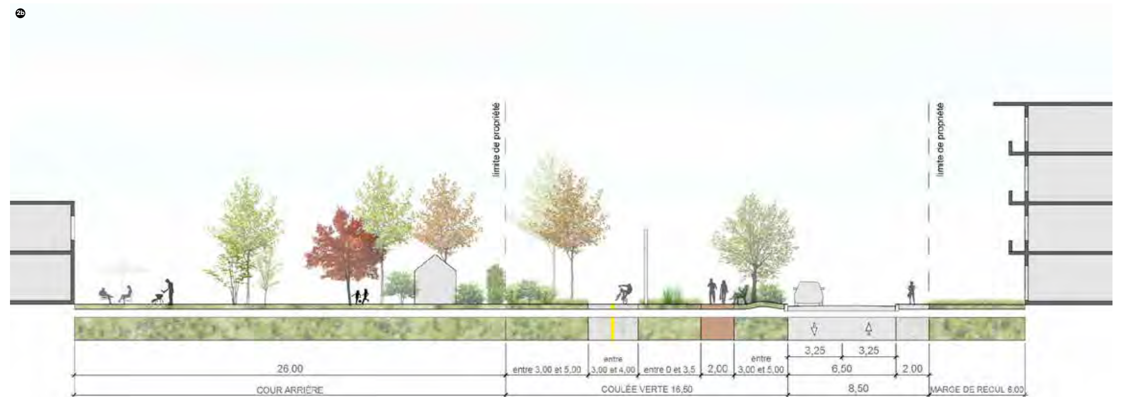
Fig. 195. Coupe type d'une piste multifonctionnelle
