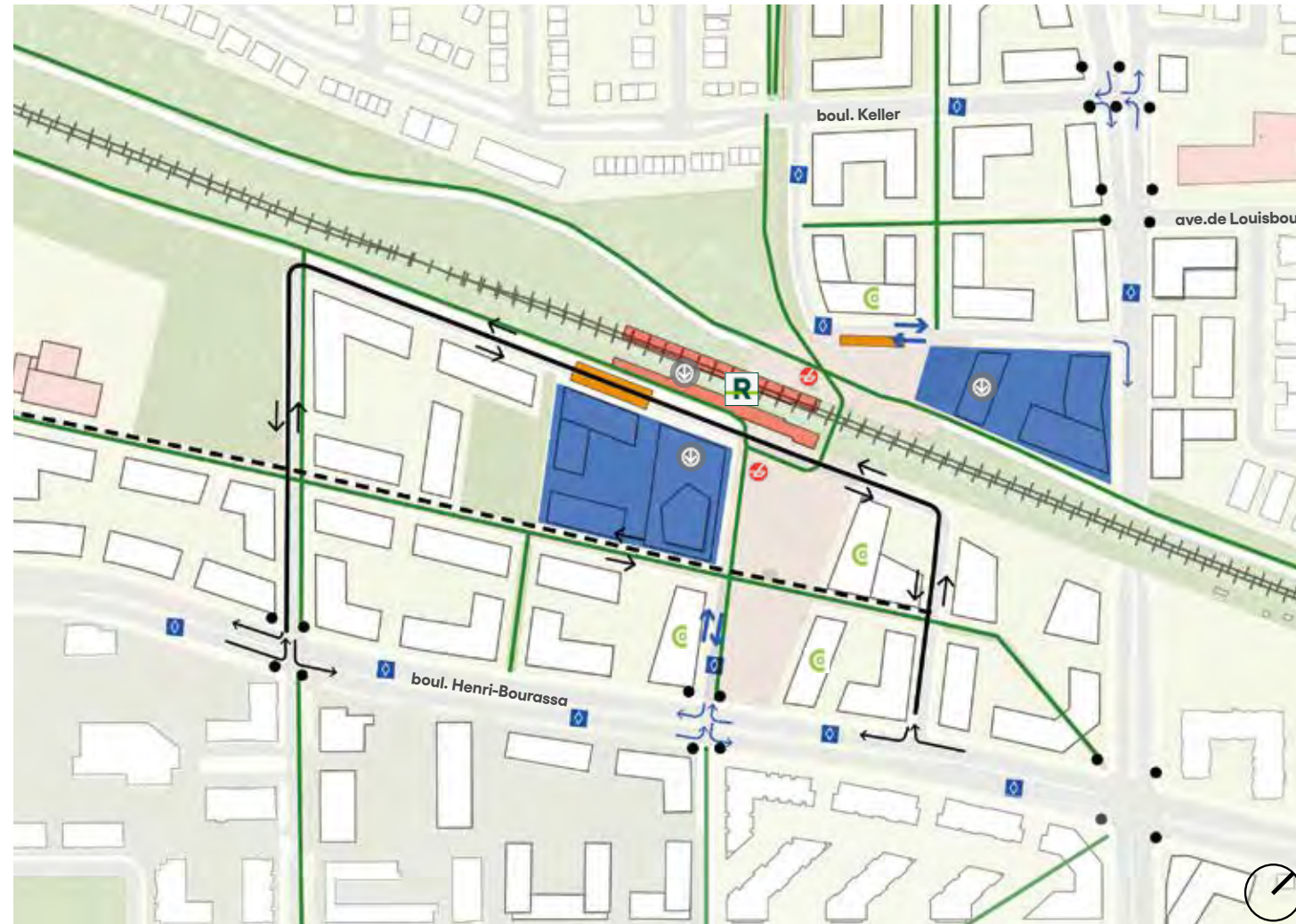
Fig. 288. Schéma des circulations et arrimage des différents réseaux aux abords de la station intermodale
