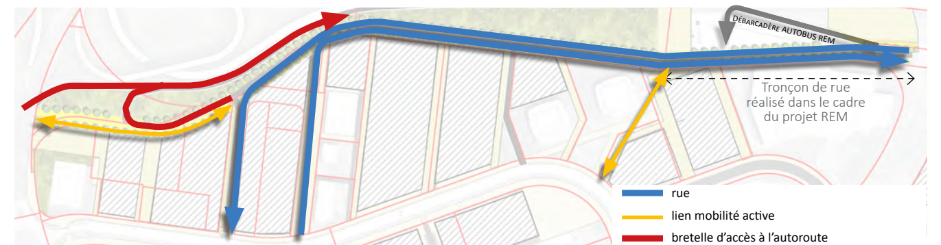
Fonctionnement potentiel de la bretelle d'autoroute A-15 sud réaménagée en rue locale
