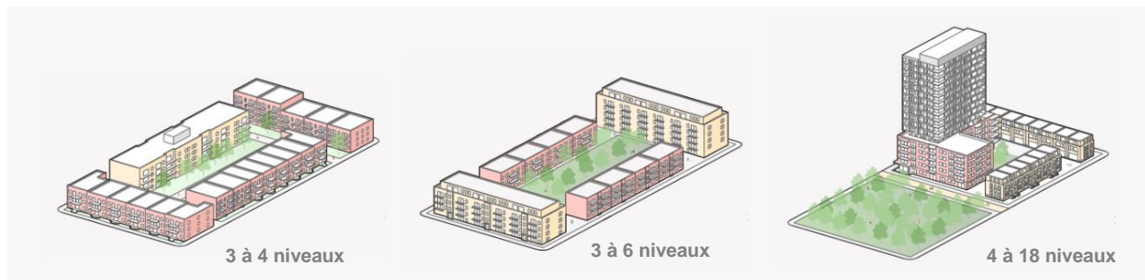
Figure 2. Trois hauteurs, une densité : comment intégrer davantage d'espaces verts et collectifs (référence : Décoder la densité [Fahey et associés, 2020]).
