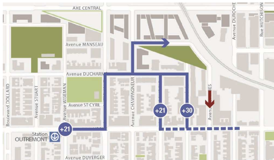
Figure 4.5 : Détournement des débits véhiculaires, mise à sens unique de l'avenue Querbes, pointe AM
