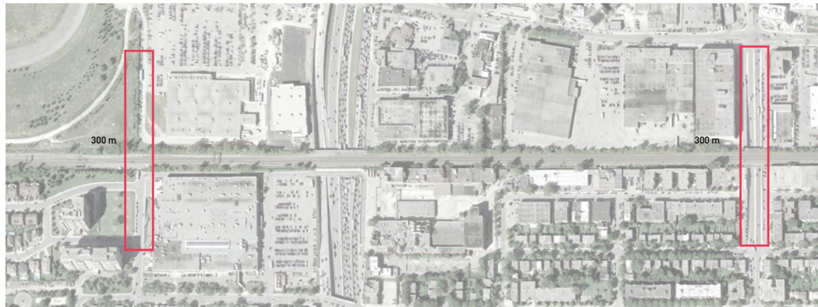
Illustration montrant la distance approximative requise pour l'aménagement d'un passage inférieur véhiculaire. À gauche, le passage envisagé dans l'axe Clanranald. À droite, le passage de la rue Victoria. Source : Google Maps, 2017
