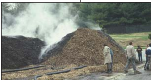
Piles statiques sous aération forcée Photo : SOLINOV
