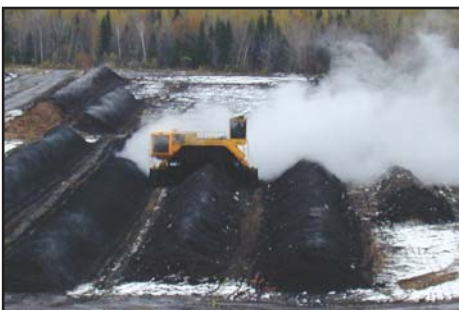
Compostage en andains retournés sur aire ouverte Photo : SOLINOV
