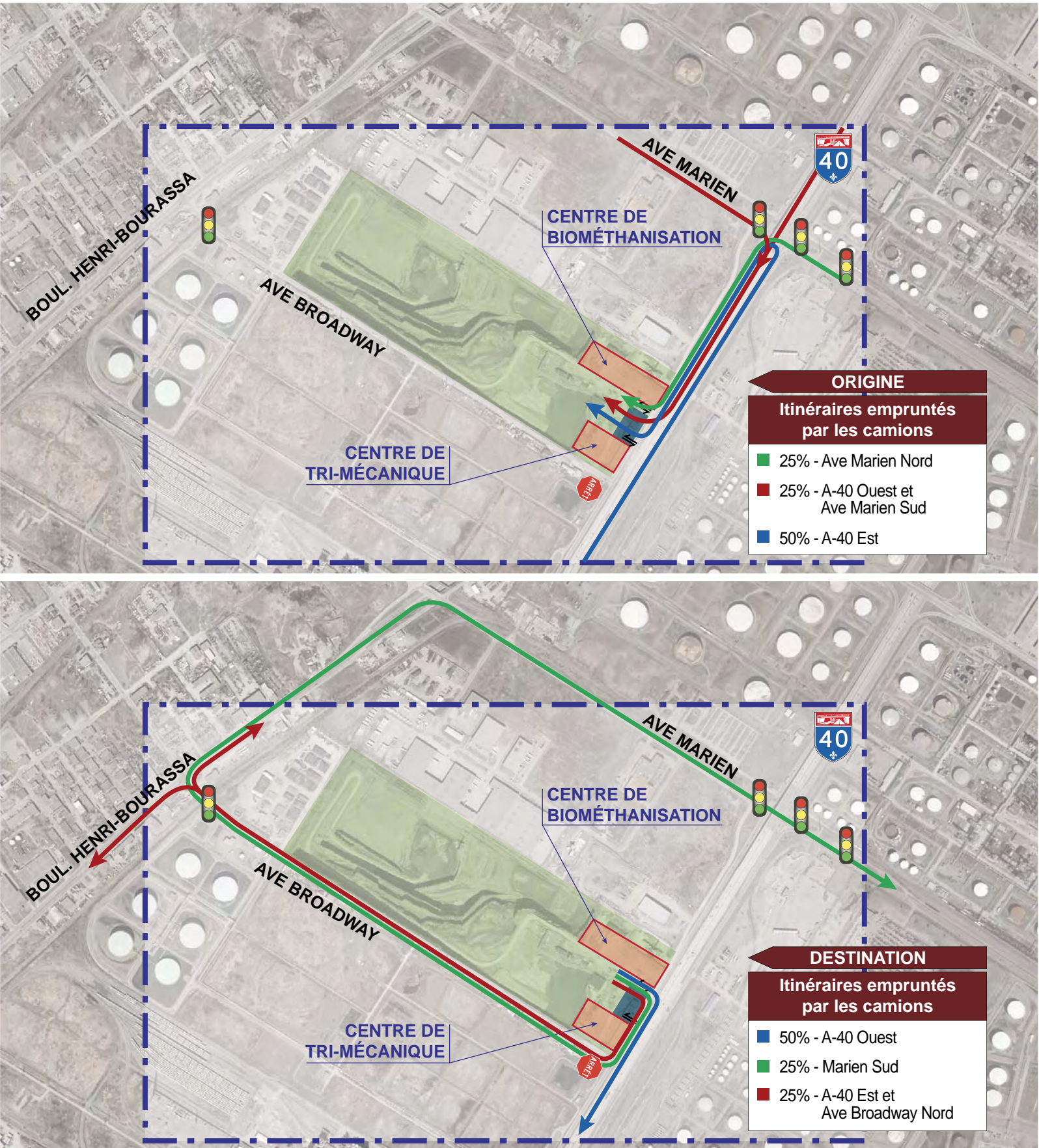
FIGURE 3.1 DISTRIBUTION DES DÉPLACEMENTS
