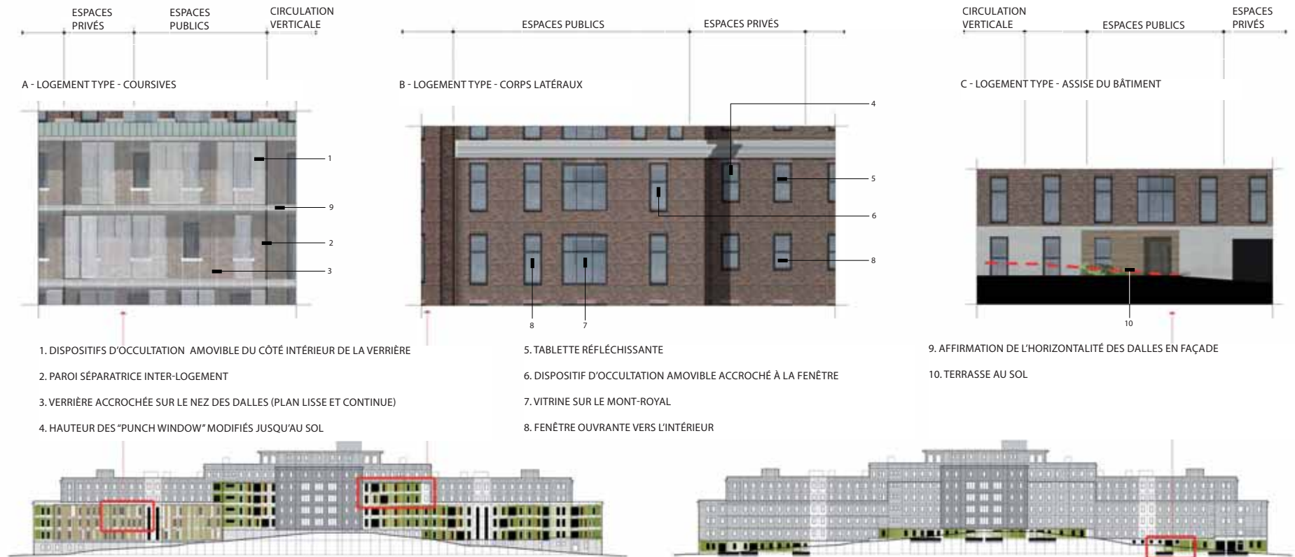
Figure 34 - Détails d'élévation, façades sud extérieures
