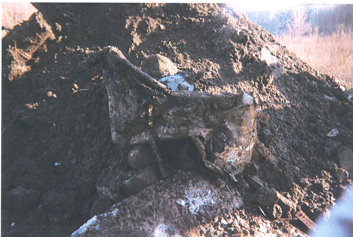
PHOTO N° 2 Remblai contenant environ 40% de débris (TR-9)
