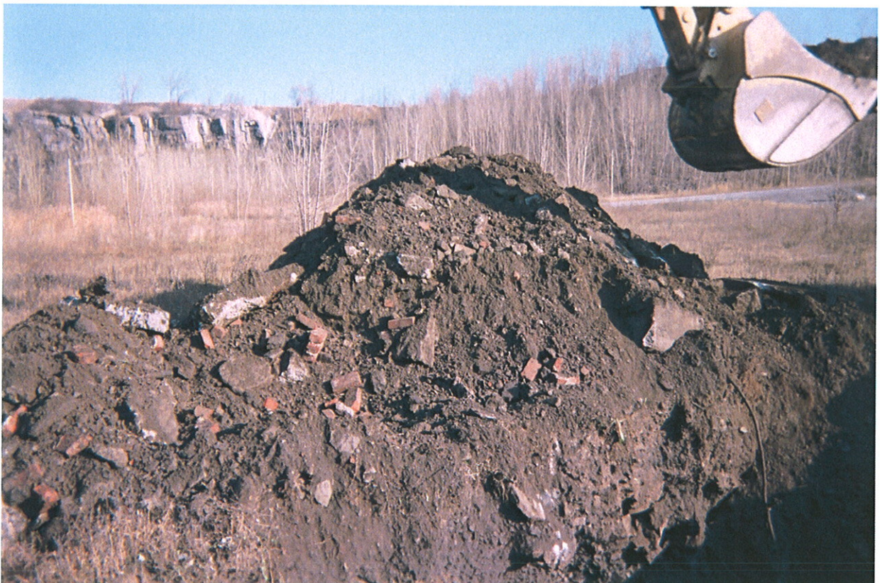
PHOTO N° 6 Remblai contenant environ 65% de débris (TR-15)
